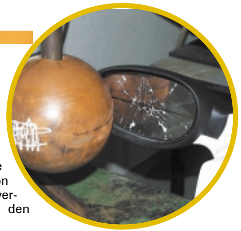
Pendelschlagprüfung: Klappt der Spiegel bei einem Aufprall vorschriftsmäßig ein?
