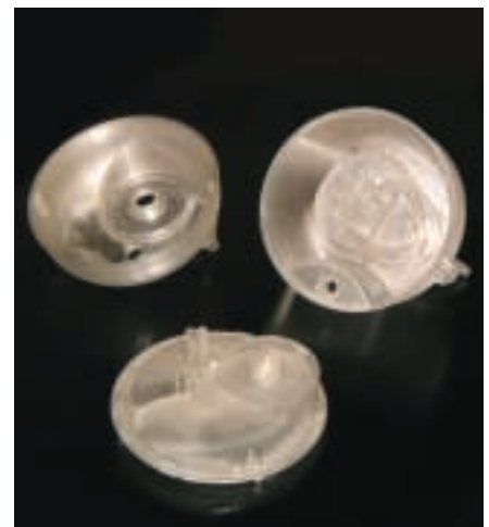
Eine erfolgreiche Anwendung der Stereolithographie bei Dideco wird durch die Passformtests des Lilliput Minicardiotom veranschaulicht
