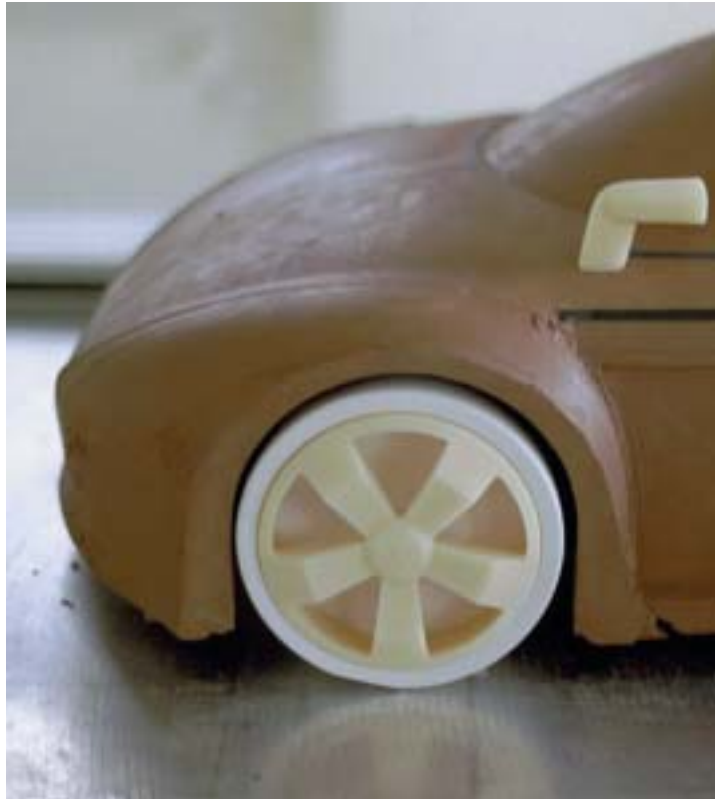
Die Form der Radfelge und des Rückspiegels werden am maßstabsgetreuen Modell des Fahrzeugs überprüft
