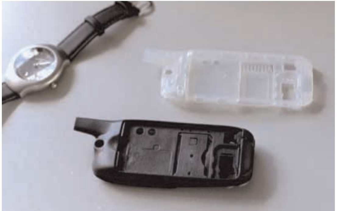
Gerätegehäuse des Mobilfunktelefons aus Stereolithographie im rohen und im eingefärbten Zustand
