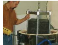
Mettere nel forno la sinterizzazione e infiltrare
