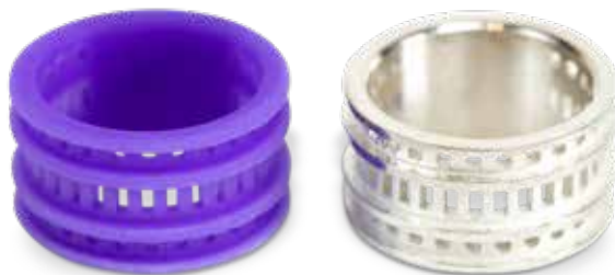
Ring in Visijet M2 CAST gedruckt und in Silber gessoed
