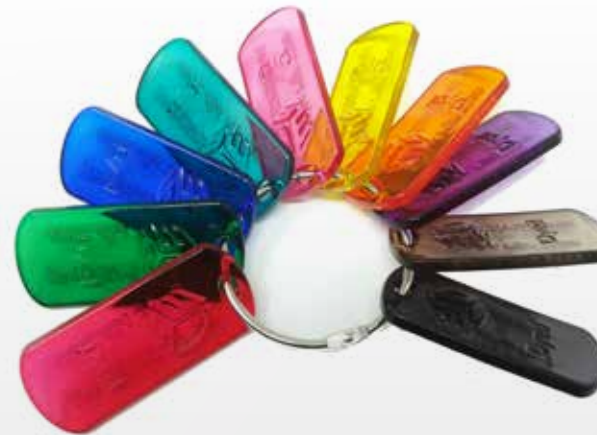
Farbschlüsselanhänger aus Visijet M2R-CL mit Klarlackbeschichtung, eingefärbt mit Standardfarben mit 1%iger Konzentration (60 °C und 30 min)
