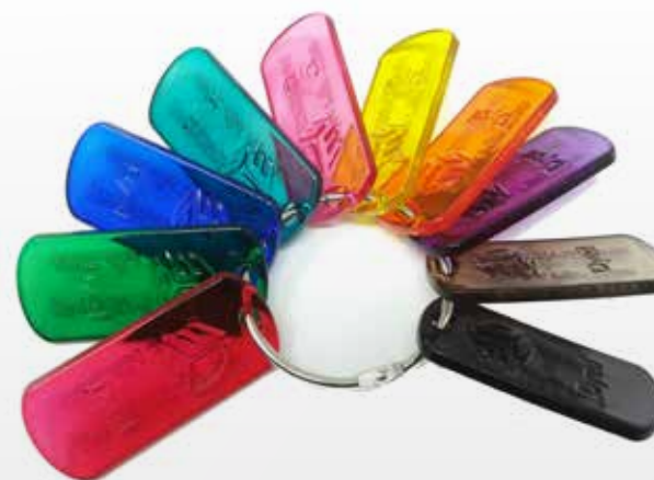
濃度 1% の標準カラーでクリアコート染め (60 °C で 30 分) した Visijet M2R-CL 製カラーキーリング。
