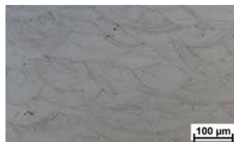
Microstruttura senza trattamento termico (NHT)
