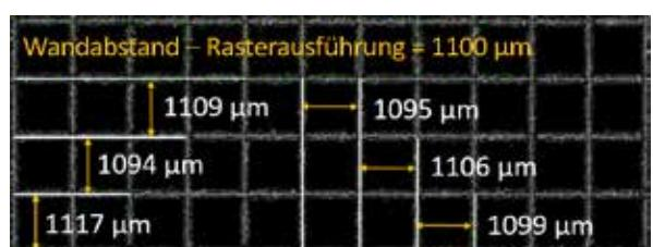
Die additive Fertigung ermöglicht einen genauen Wandabstand.
