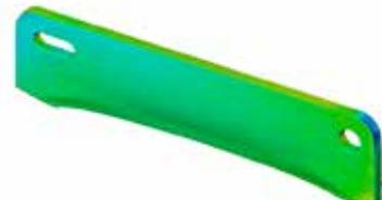
**Alta precisione** dopo la rimozione del supporto e la sabbiatura in base alle misurazioni rilevate mediante scansione 3D.
